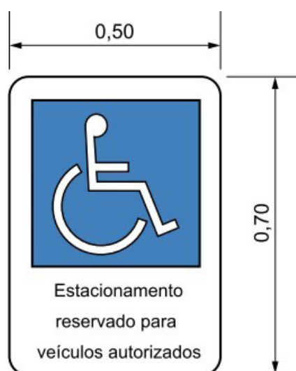
Figura 47: Sinalização vertical para vaga de deficientes.
