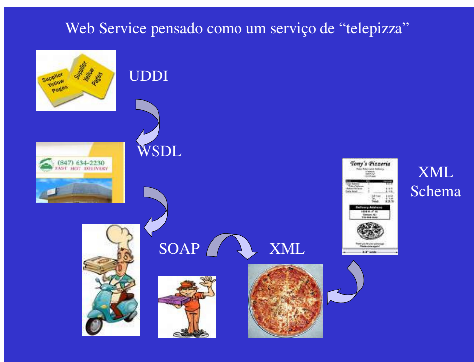
Figura 17 – Idéia de funcionamento de web services por comparação com serviço de Tele Pizza
